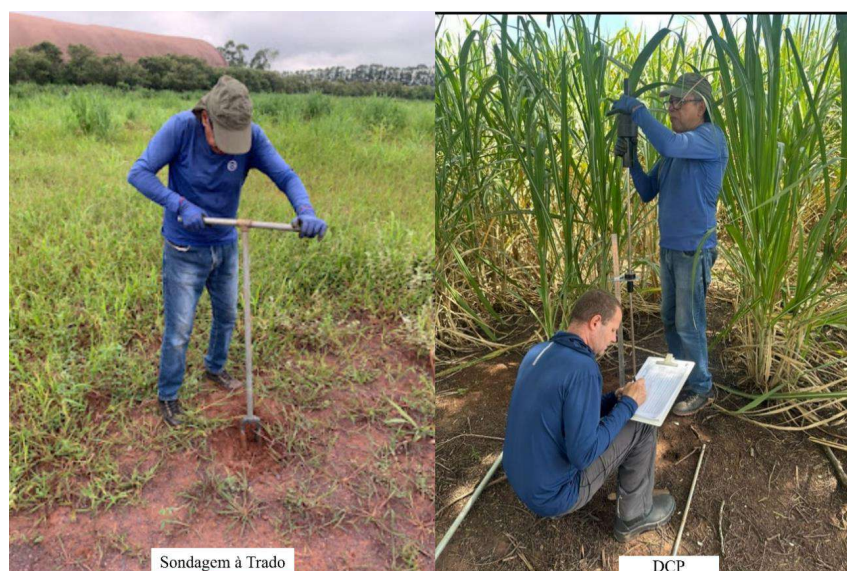
Figura 5 – Sondagem e DCP
