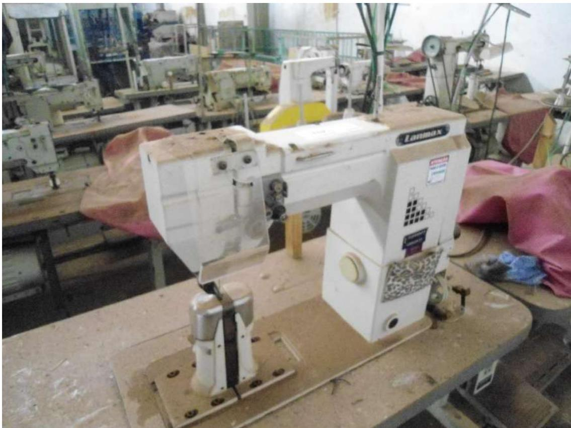
8. Máquina de costura **MARCA LANMAX modelo LM-9920 – 2T** máquina de coluna transporte triplo de duas agulhas, com motor elétrico, e em regular estado de conservação, patrimônio 039.
