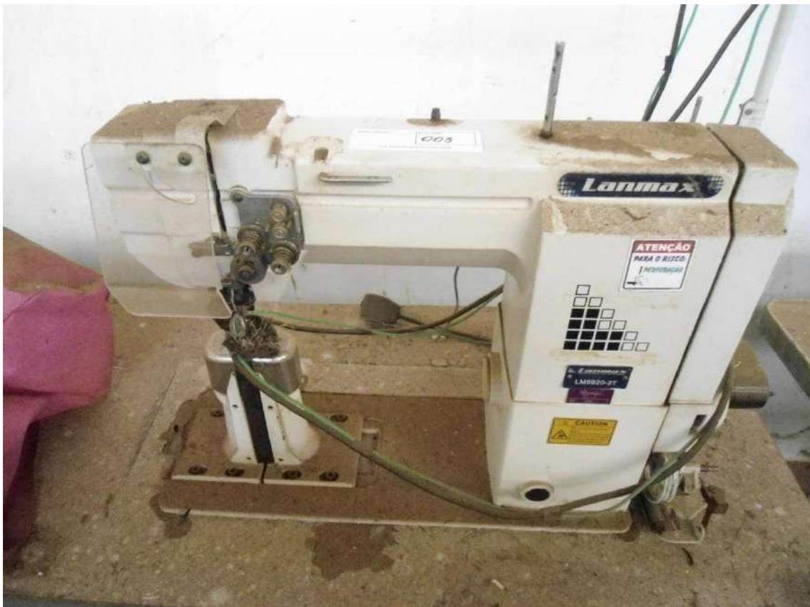
4. Máquina de costura **MARCA LANMAX modelo LM-9920 – 2T** máquina de coluna transporte triplo de duas agulhas, com motor elétrico, e em regular estado de conservação, patrimônio 034.
