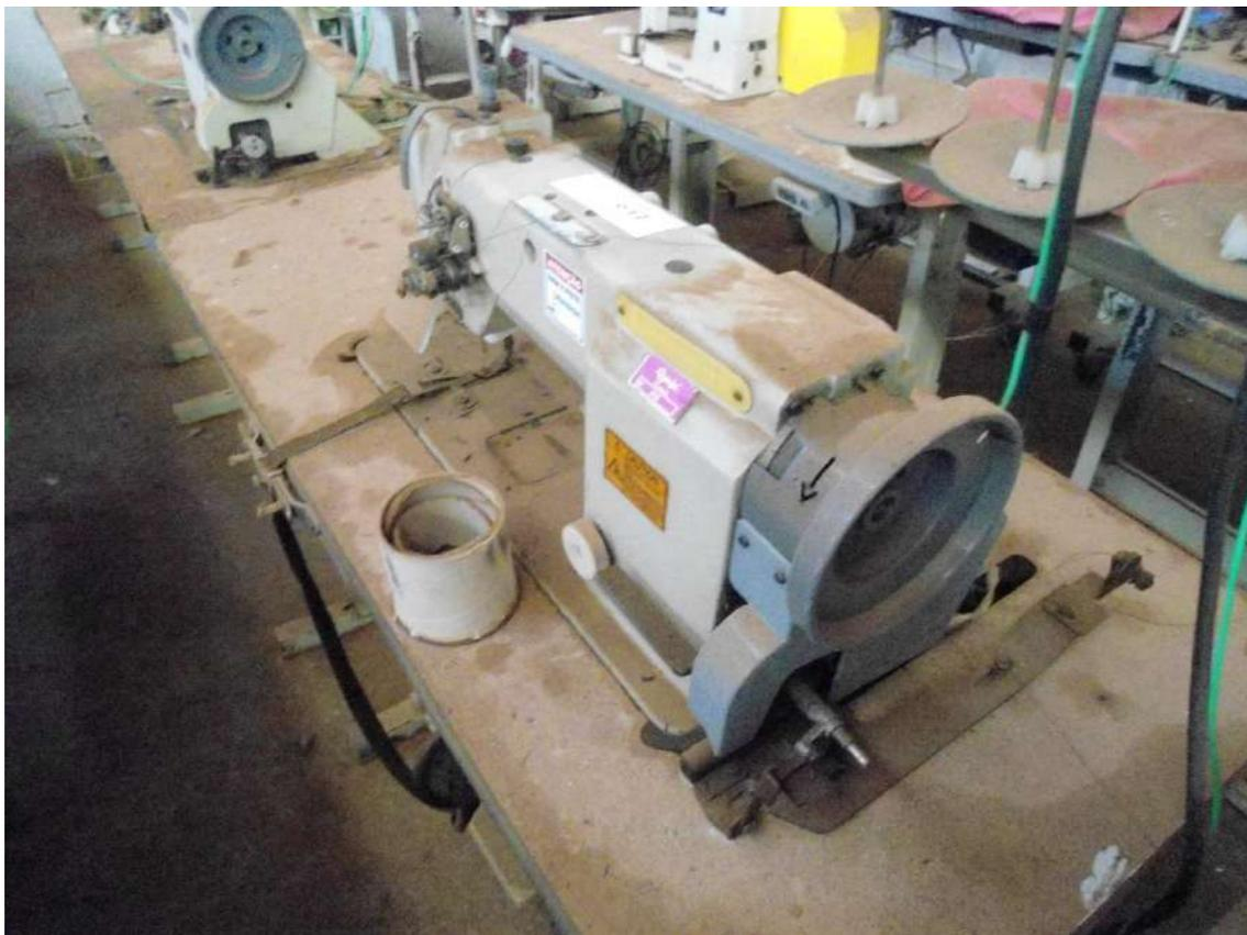
18. Máquina de costura **MARCA LENMAX modelo GC 20518 B**, máquina de costura pespontadeira de duas agulhas, transporte triplo, com motor elétrico, em bom estado de conservação, patrimônio 035.
