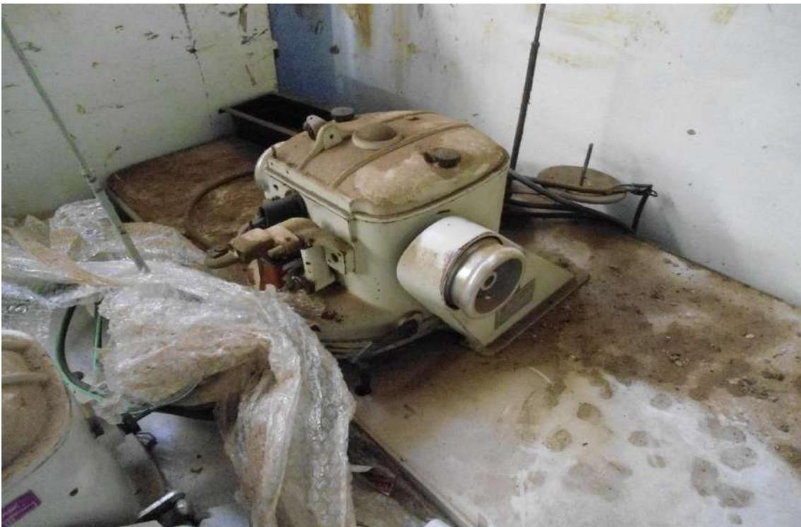
28. Máquina de montar bico **MARCA TOCCHETTO modelo TM-04**, nº série 86121693.
