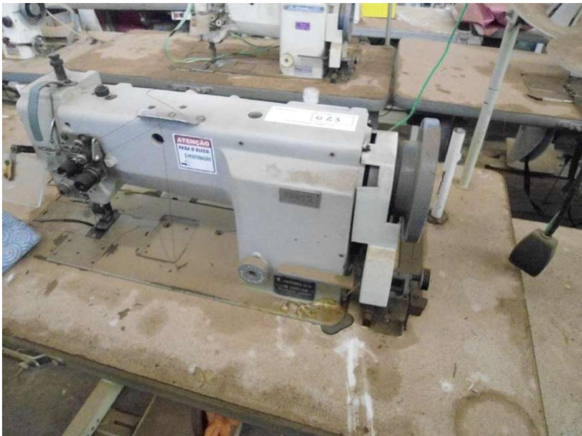
24. Máquina de costura **MARCA LENMAX modelo LM 9100 LM**, travete eletrônico, laçadeira pequena, com motor elétrico, rotação de 2700 rpm, regular estado de conservação, patrimônio 0479.
