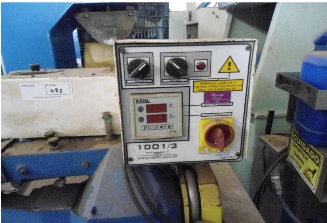
83. Máquina de cambrear gáspeas **MARCA MORBACH** modelo **M22 ES**, pressão de 80 lbs/pol<sup>2</sup>, capacidade de 90 pares por hora, regular estado de conformação.
