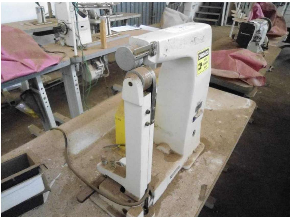
14. Máquina de coluna de uma agulha **MARCA TECHOOK modelo TK 810**, de transporte simples, velocidade máxima 2000 rpm, com motor elétrico, regular estado de conservação, patrimônio 122.
