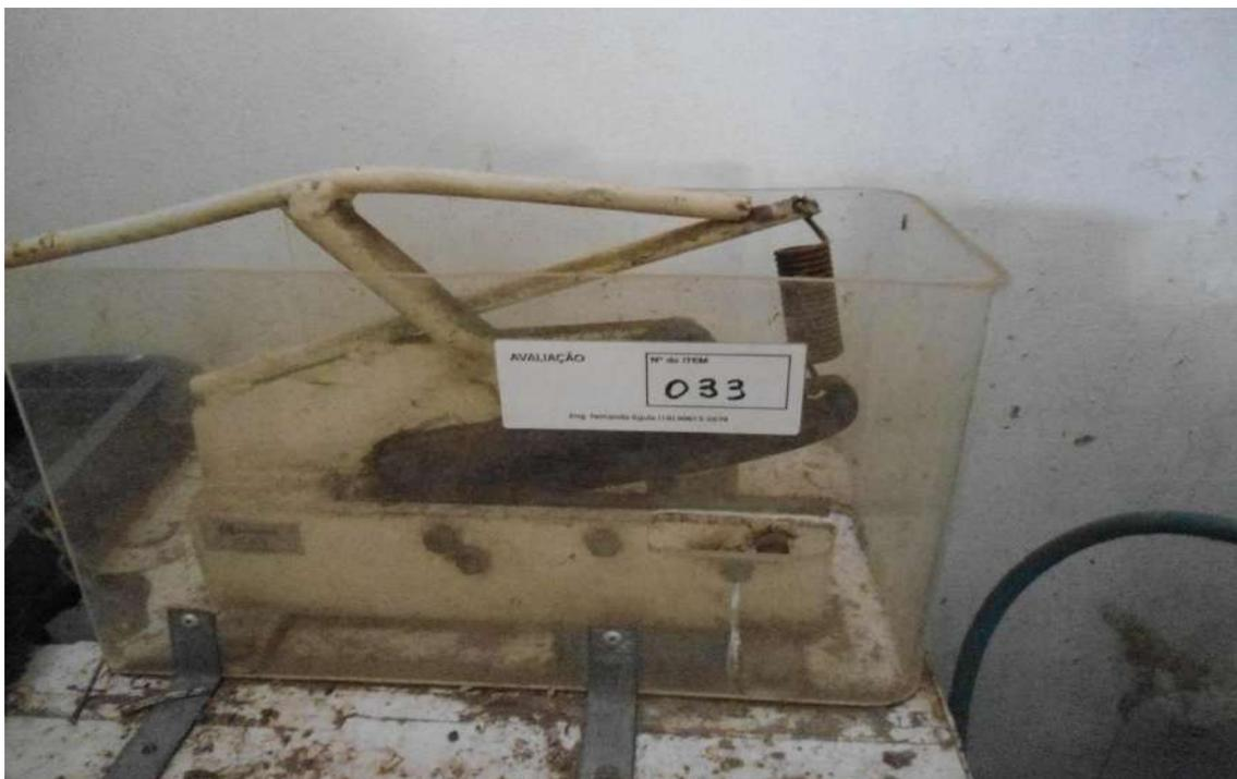
34. Máquina rebidadeira **MARCA METALÚRGICA PIPE VARIANI**, acionamento pneumático com controle por pedal, regular estado de conservação, patrimônio 390.
