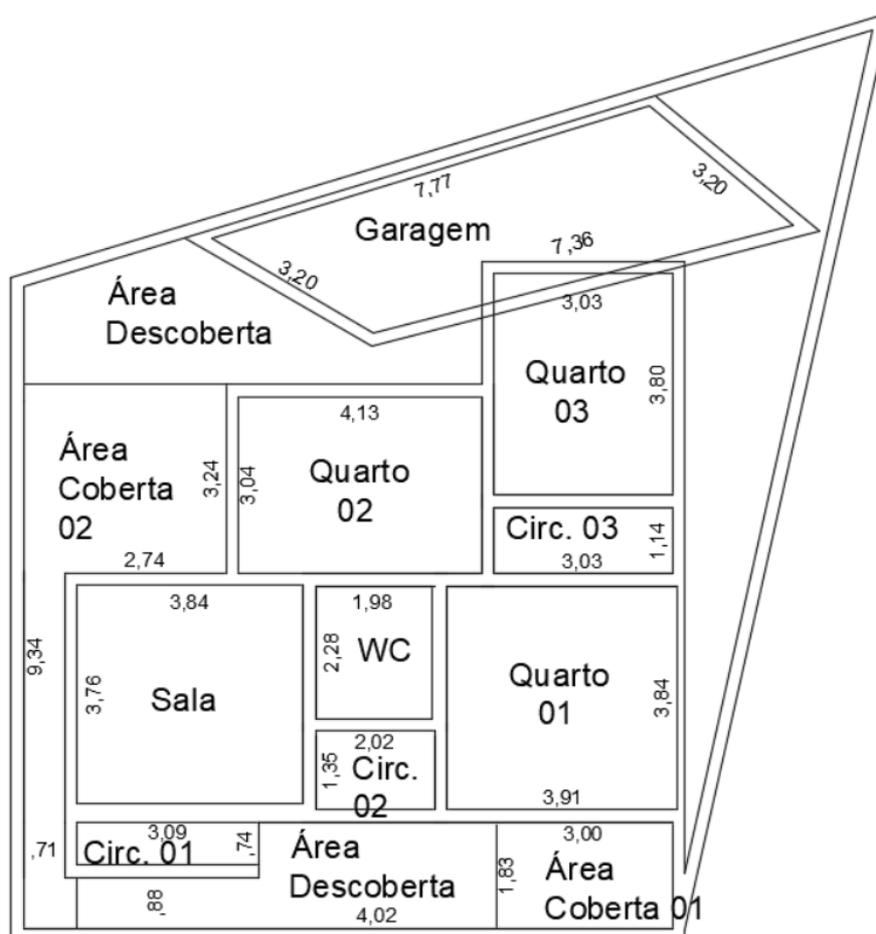
Figura 15 - Planta do imóvel conforme medições "in loco" - Fonte: Própria
