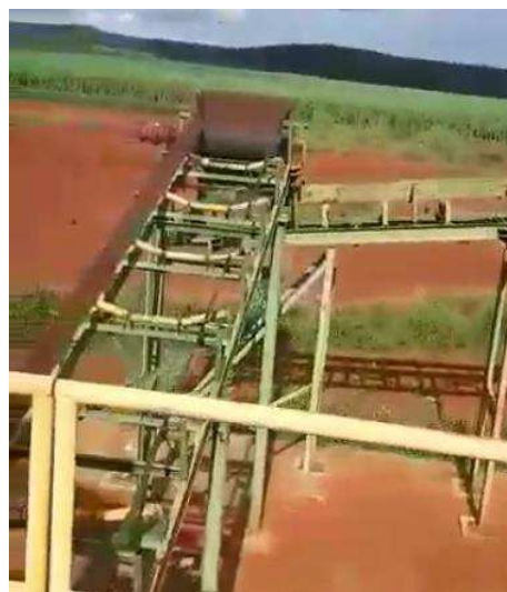
7 e 8- Reservatório de rejeito e esteira sem motores
