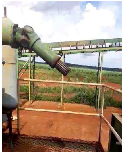
5 e 6- Redutor e conexão sem motor
