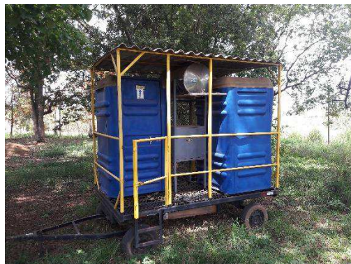
CARRETA COM 2 BANHEIROS QUÍMICOS
