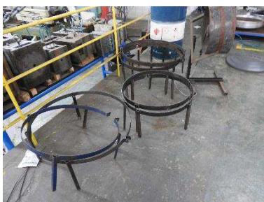
SUPORTES PARA TANQUE E INJEÇÃO
