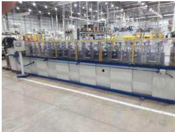
22. LINHA COMPLETA CONTENDO: FERRAMENTAL, ALIMENTADOR AUTOMÁTICO, PRENSA E PERFILADEIRA.
