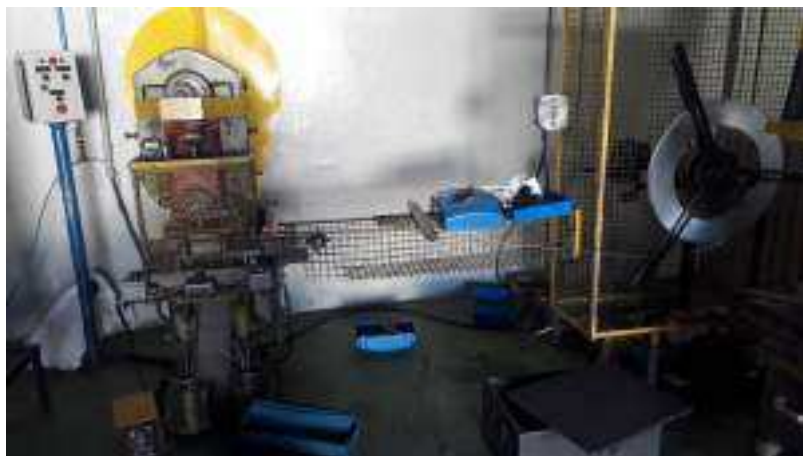
29. PRENSA EXCENTRICA GUTMANN 15 TONELADAS COM CARREGADOR DE MATERIA PRIMA
