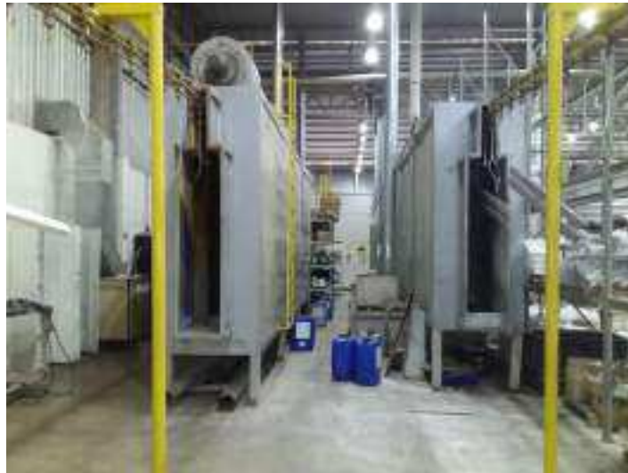
37. LINHA DE PINTURA AUTOMÁTICA COMPLETA CONTENDO: BANHO, SECAGEM, DOIS ROBÔS DE PINTURA, FORNO PARA CURA DE TINTA E PAINEL DE COMANDO
