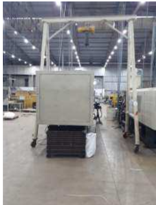
110. TALHA ELÉTRICA COM PÓRTICO
