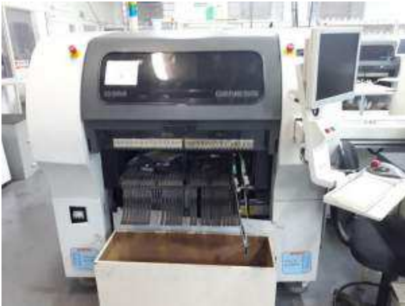
10. DUAS INSERSORAS DE COMPONENTES AUT SMT (GSM-GENESIS)
