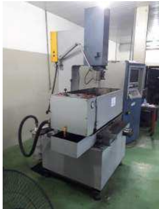
05. ELETROEROSÃO PENETRAÇÃO SUPRASONIC ZNC-30A
