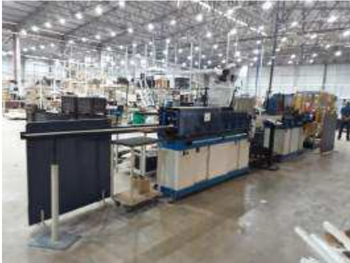
23. DUAS LINHAS PERFILADEIRAS PARA PRODUÇÃO DE REFLETOR ÓPTICO DE LUMINARIAS LED COM FERRAMENTAL
