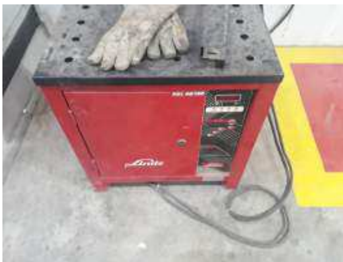
14. CARREGADOR DE BATERIA DA EMPILHADEIRA LINDE R17
