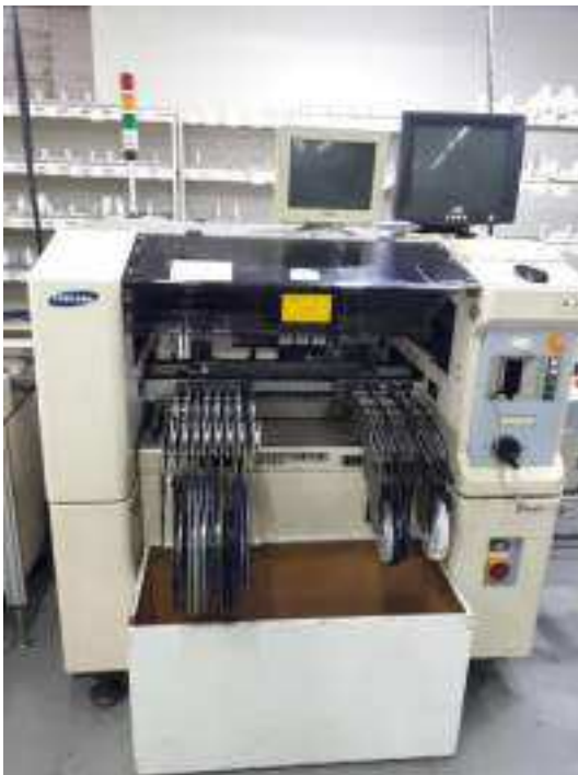
12. DUAS INSERSORAS DE COMPONENTES SAMSUNG CP 40 LV
