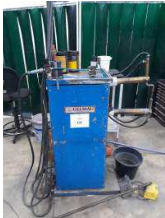
21. DUAS MAQ SOLDA PONTO 25KVA 100A GLUMAU
