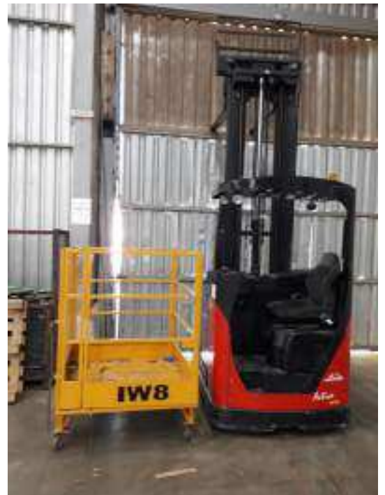
14. EMPILHADEIRA LINDE R17 ELÉTRICA
