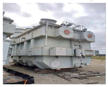
**Descrição:** AUTOTRANSFORMADOR HITASCHI, NS. 701672-1
