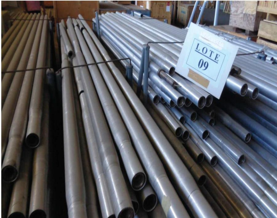
**Descrição:** TUBOS DE ALUMINIO COM CONEXÕES DE COBRE NAS EXTREMIDADES **PMV:** 45.000,00
